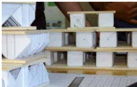
Studentische Prototypen neuartiger Stützstrukturen aus gefaltetem Papier als Kernschicht für Sandwichplatten. Die Prototypen müssen sich in Prüfungen zur Druckfestigkeit bewähren. Foto: Prof. Martin Stosch, Hochschule OWL
